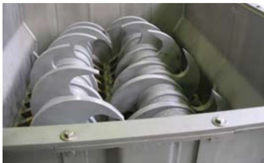
Дробилка для замороженных брикетов с двумя валами
