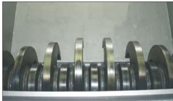
Дробилка для замороженных брикетов с одним валом
