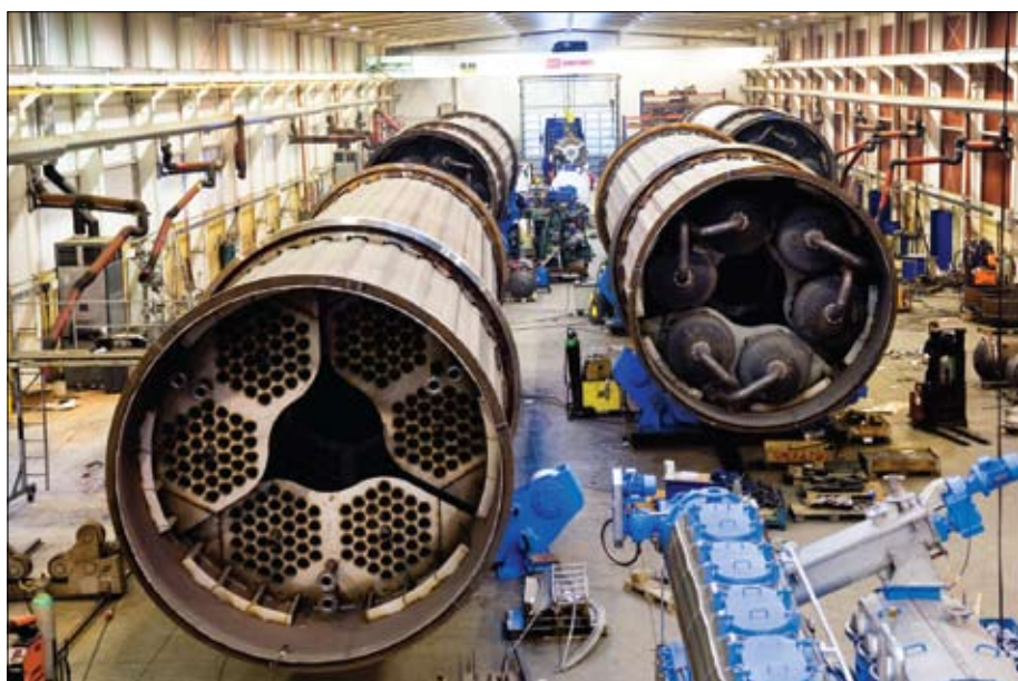
4 sécheurs RTD installés chez Lantmännen Agroetanol AB en Suède pour le séchage mécanique des produits de distillation. Chaque machine représente une surface de chauffage de 1900 m 2 , et les quatre sécheurs produisent ensemble une évaporation totale de 40.000 l/heure.
